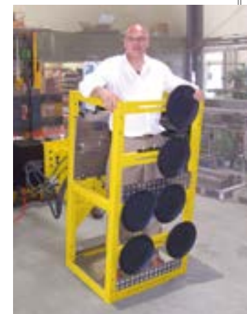
Nacelle avec système à ventouses
